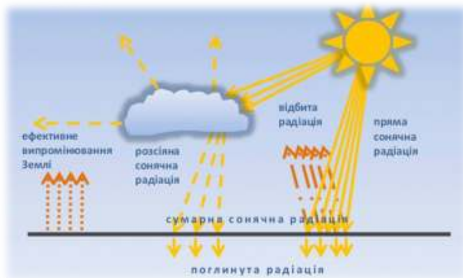
Рис.1. Сонячне опромінення має такі компоненти: пряму, розсіяну та відбиту радіації
